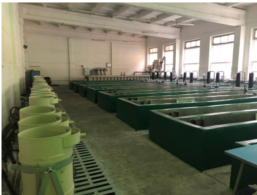
Рисунок 3 – Размещение аппаратов Вейса во внутренней части бассейнового участка
